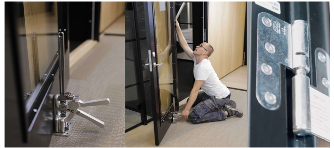
Lever les portes lourdes et les dégonter
